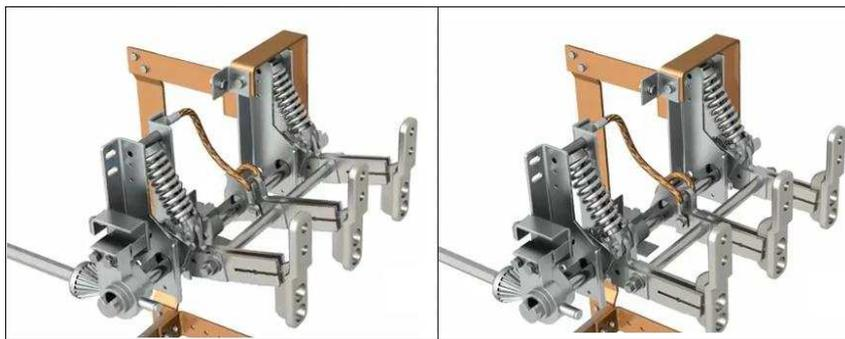
Figura 44. Secuencia de cerrado de seccionador de puesta a tierra<sup>17</sup>.
